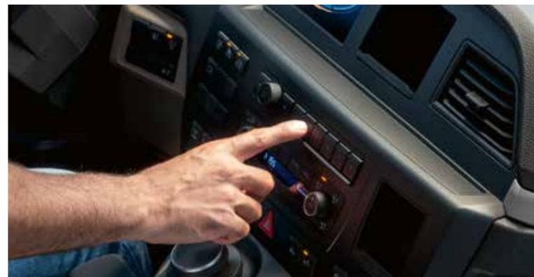
El panel de control combinado tiene en cuenta el campo de visión del conductor y en él se muestra la información relativa a la conducción, los datos de los sistemas de asistencia al conductor, las advertencias, las alertas y mucho más. En un lateral cuenta con una pantalla secundaria para la navegación a través del módulo de infoentretenimiento.
