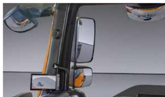
El sistema de asistencia al giro por vídeo (VTA) es un sistema independiente para aquellos vehículos que no contaban con ningún sistema de asistencia al giro hasta el momento. Si el vehículo ya dispone de este sistema de serie, el sistema de cámara lateral (SCS) se puede instalar como postequipamiento.
