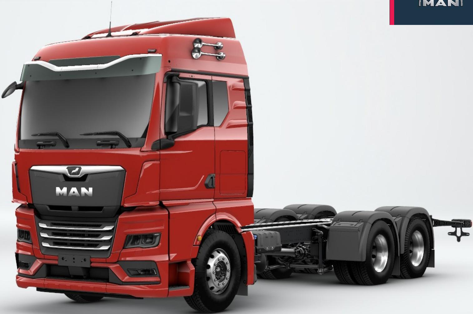
**Cabina GM: Ancha techo alto (ancha, larga, altura media) , una litera.**
