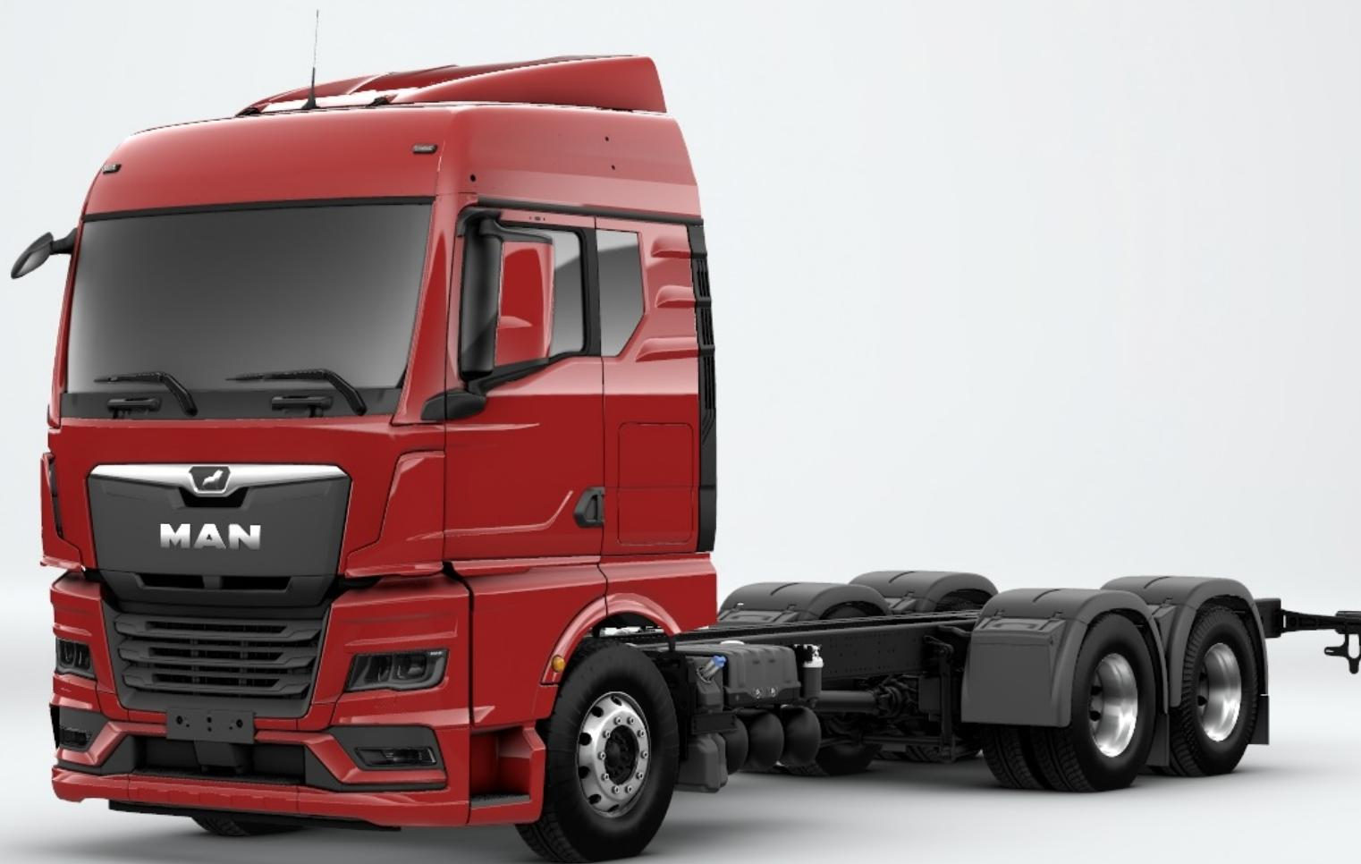
**Cabina GM: Ancha techo alto (ancha, larga, altura media) , dos literas.**
